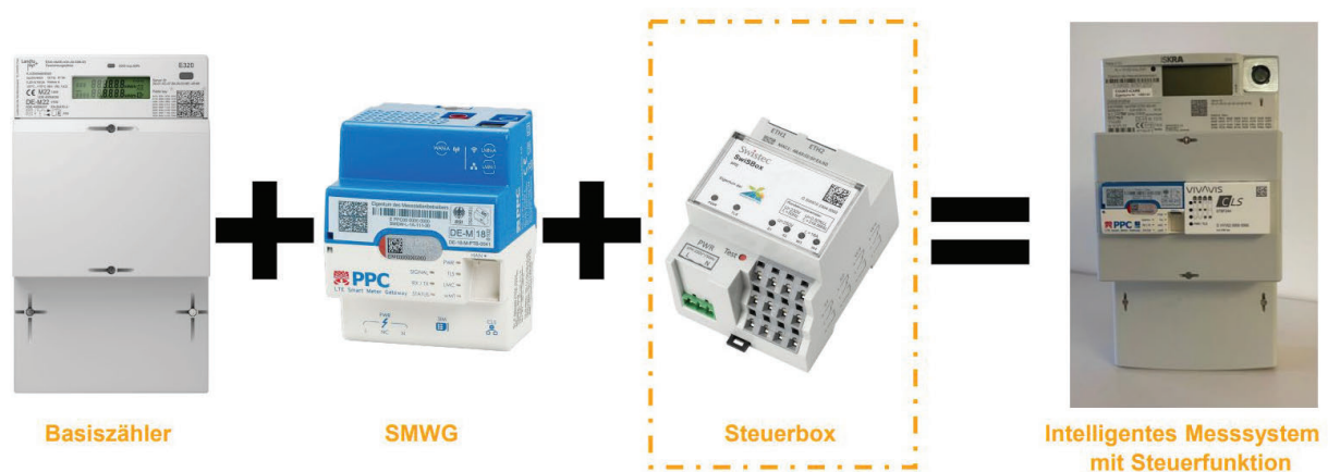
Abbildung II-77: Steuerinfrastruktur beim Endverbraucher (Eigene Darstellung)
